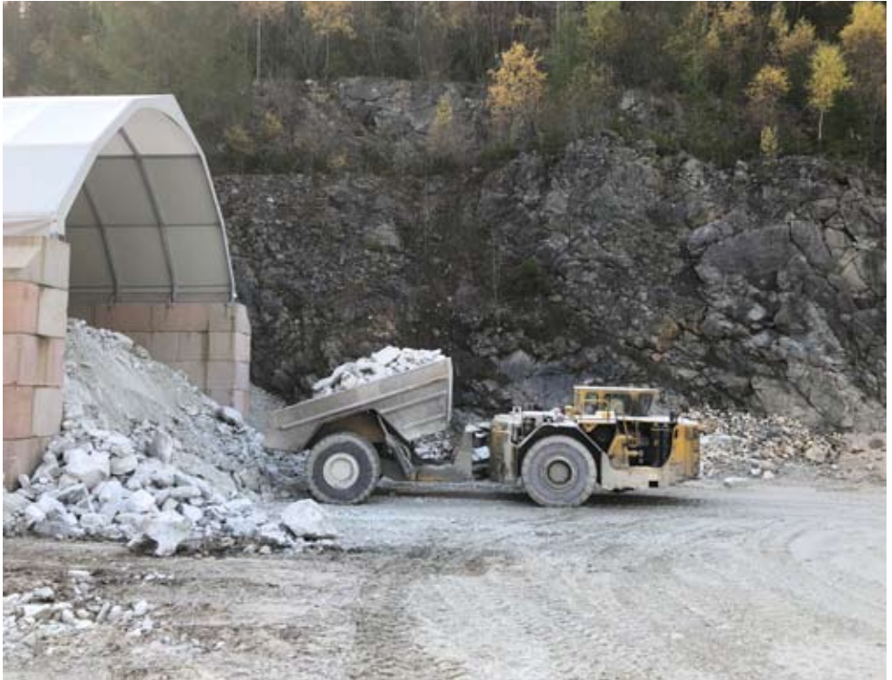
Am Standort GEOMIN in Hammerunterwiesenthal – ein Muldenkipper entlädt den untertägig gewonnenen sächsischen Marmor in ein Zwischenlager. Alle Fotos © O.Alich/VBGU
