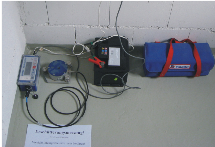
Abb. 1: Erschütterungsmessgerät im Einsatz
